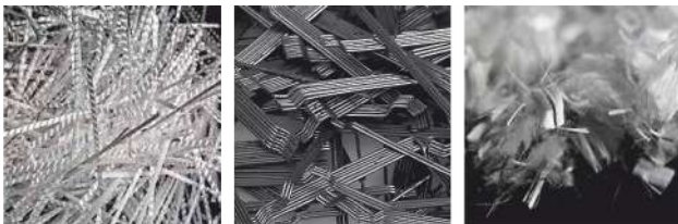
Фиг.3. Видове влакнести пълнители: полиетиленови, стоманени и полипропиленови
