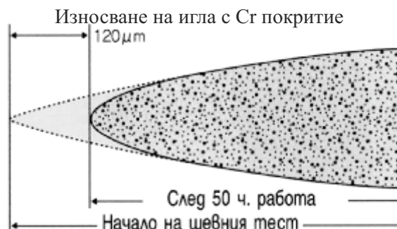
Фиг. 5 Тест за износване на иглата
